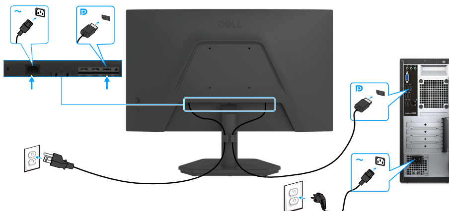
Afbeelding 15. De DisplayPort-kabel aansluiten
