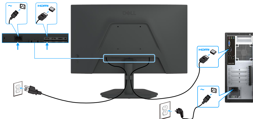
Afbeelding 14. De HDMI-kabel aansluiten
